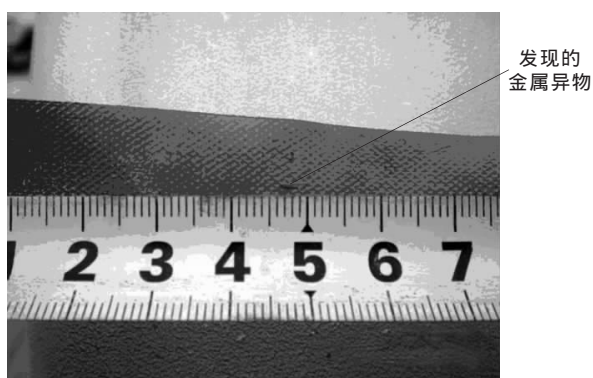
图2 螺丝孔中脱落的金属异物
